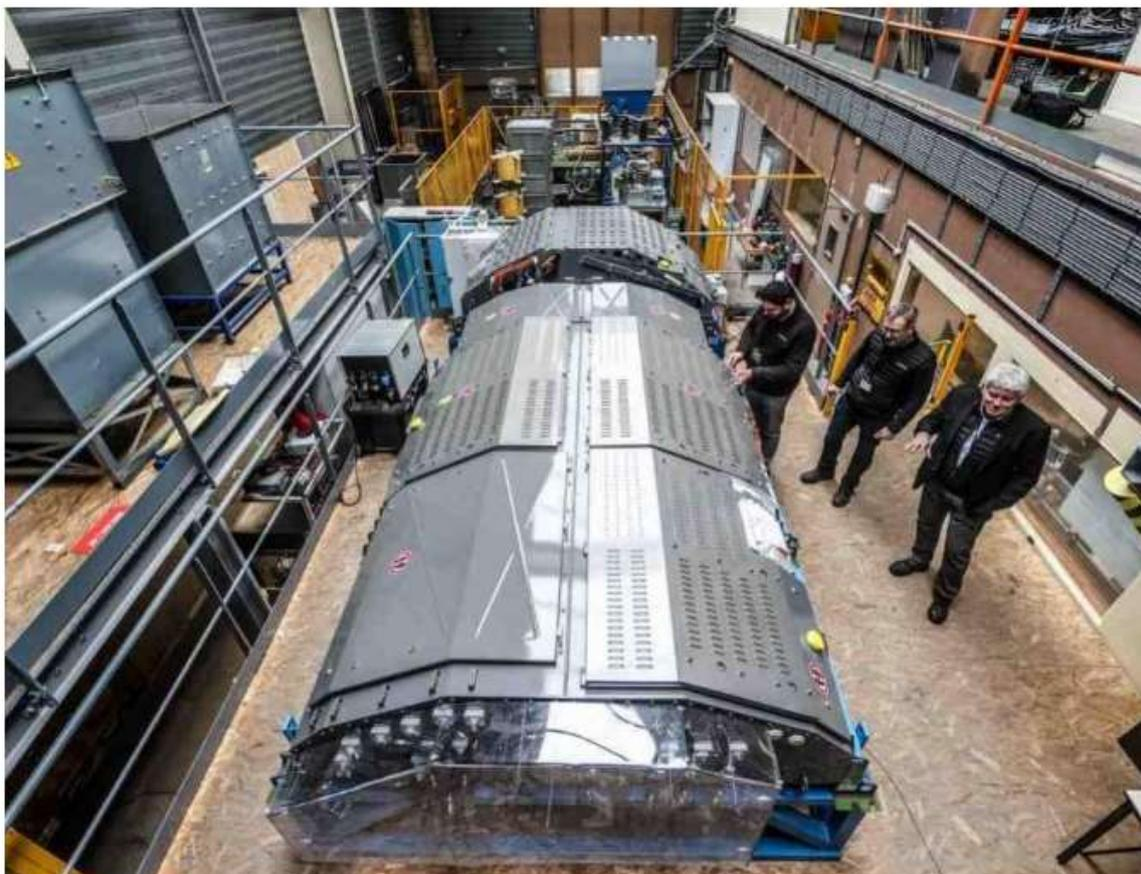
*Le site d'Alstom de Tarbes est en charge de la traction ferroviaire. Il développe notamment les systèmes installés sur les trains à hydrogène. Ici, l'ensemble qui permet de convertir l'énergie pour faire avancer le train. - DAVID LE DEODIC / SO*
